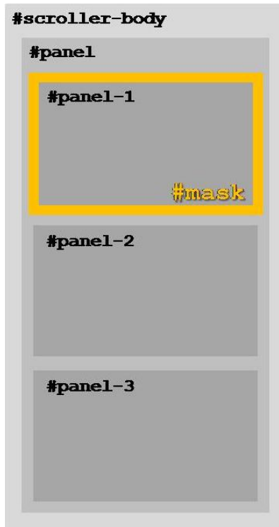
Figura 4.3: Schema della struttura utilizzata per la realizzazione di schede a transizione scorrevole
